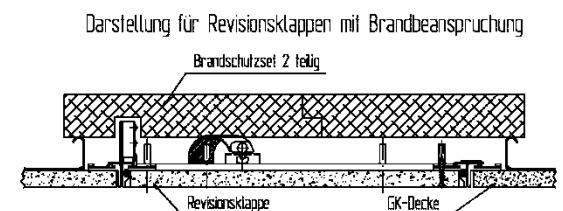
6. Klappen einhängen, sichern und verschließen
